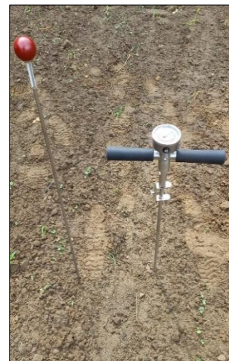
Abb. 1 Bodensonden ohne (links) und mit (rechts) Druckmesser
